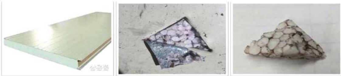
[그림 3-2] 대한에스피에 사용된 샌드위치 판넬 심재인 발포폴리스틸렌
