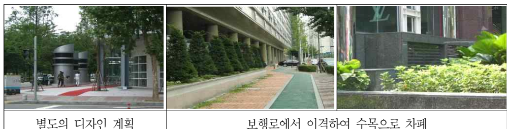
[그림 2-6-1] 환기구 설치 예시도
